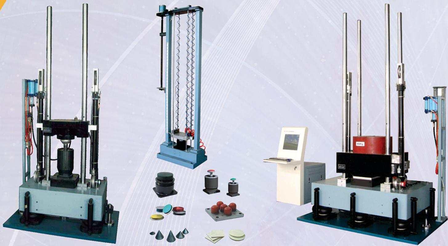
سیستم‌های آزمون شوک مکانیکی به روش سقوط آزاد بر روی پدهای شوک مخصوص می‌توانند جهت انجام آزمون‌های شوک مطابق با استانداردهای بین المللی با شکل موج‌های زیر شرایط واقعی شوک را شبیه سازی نمایند:
